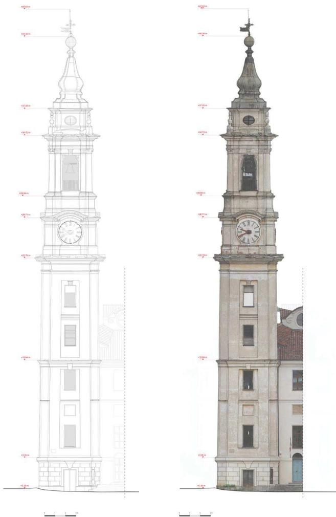
In alto: rilievo metrico 3D, prospetto sud (2020).
