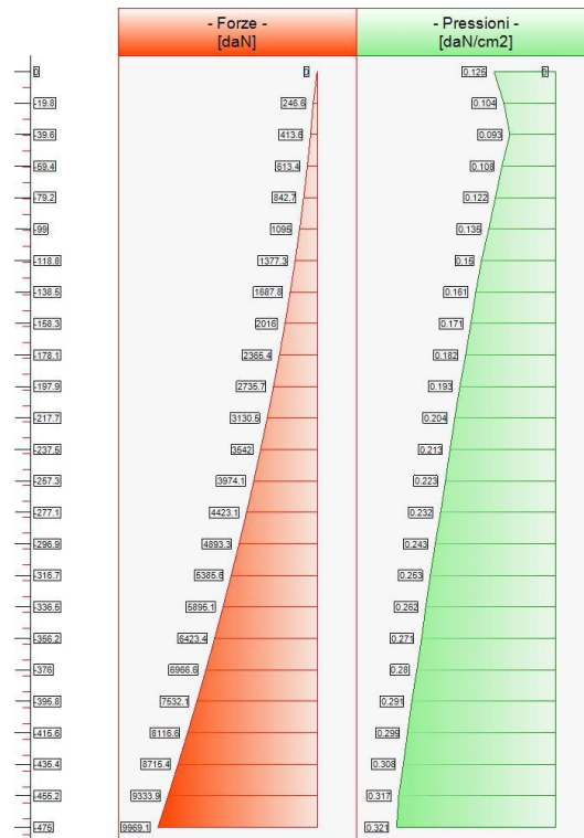
Forze (totali) e Pressioni lungo il fusto, per il Caso 6 ( STR_SISMA_GIU [ SLU ] - SLU_Str_Sisma_Giu (appr.2) )
