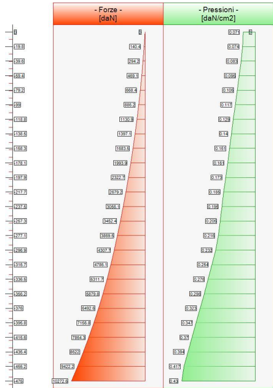
Forze (totali) e Pressioni lungo il fusto, per il Caso 5 ( EQU_SISMA_SU [ SLU_EQU ] - SLU_Equ_Sisma_Su (per equilibrio) )
