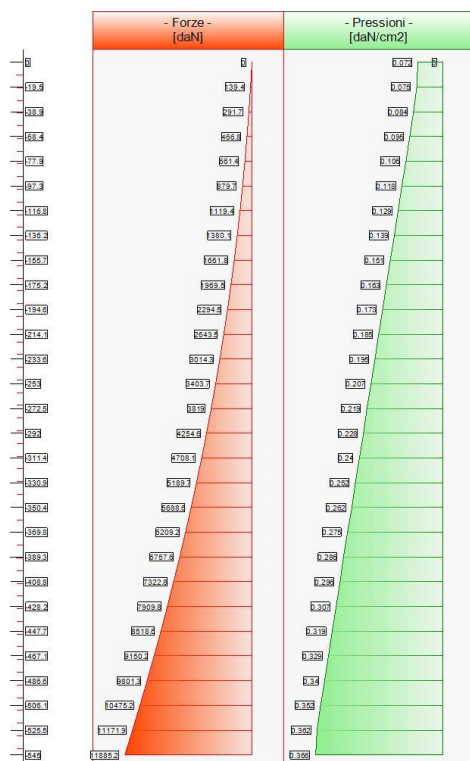
Forze (totali) e Pressioni lungo il fusto, per il Caso 7 ( GEO_SISMA_GIU [ SLU_GEO ] - SLU_Geo_Sisma_Giu (appr.2) )
