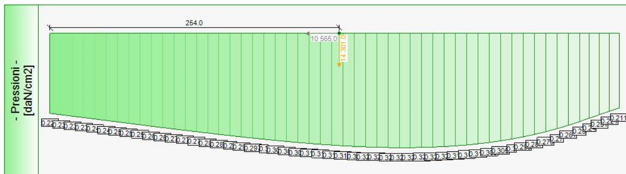
Pressioni sul terreno, per il Caso 6 ( STR_SISMA_GIU [ SLU ] - SLU_Str_Sisma_Giu (appr.2) )
