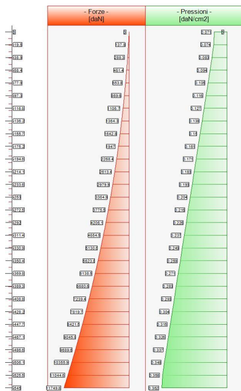
Forze (totali) e Pressioni lungo il fusto, per il Caso 5 ( EQU_SISMA_SU [ SLU_EQU ] - SLU_Equ_Sisma_Su (per equilibrio) )
