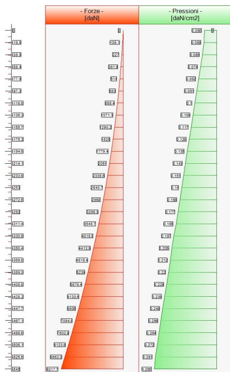
Forze (totali) e Pressioni lungo il fusto, per il Caso 3 ( STR_SISMA_SU [ SLU ] - SLU_Str_Sisma_Su (appr.2) )
