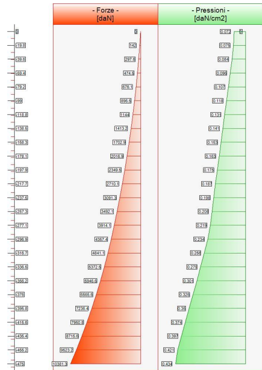
Forze (totali) e Pressioni lungo il fusto, per il Caso 8 ( EQU_SISMA_GIU [ SLU_EQU ] - SLU_Equ_Sisma_Giu (per equilibrio) )
